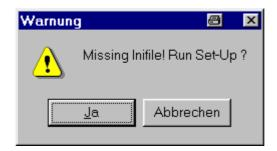
Klicken Sie jetzt auf "Ja", um bei der Erstinstallation die erforderliche Initialisierungsdatei zu erstellen. Die Software analysiert daraufhin Ihr System auf vorhandene serielle Schnittstellen (Dauer ca. 5 Sekunden) und meldet sich dann mit dem untenstehenden Bildschirm:
